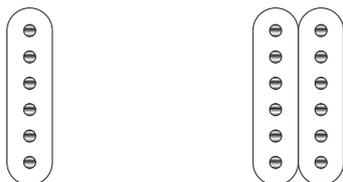
À gauche un micro simple bobinage, à droite un micro double bobinage
